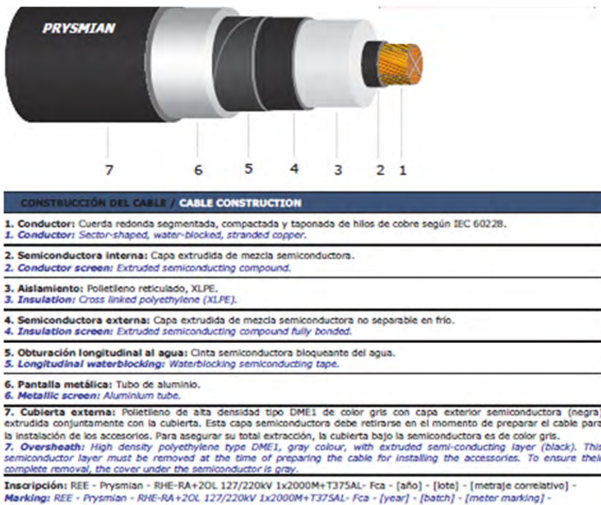
Detalle cable conductor.
